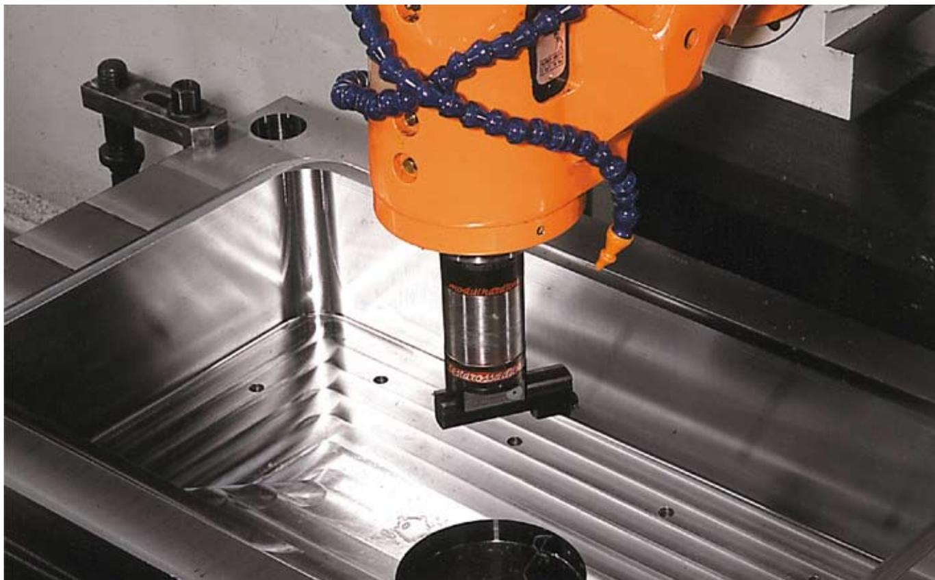
*Un momento della lavorazione di fresatura per un portastampo in Sefa Meccanica*
