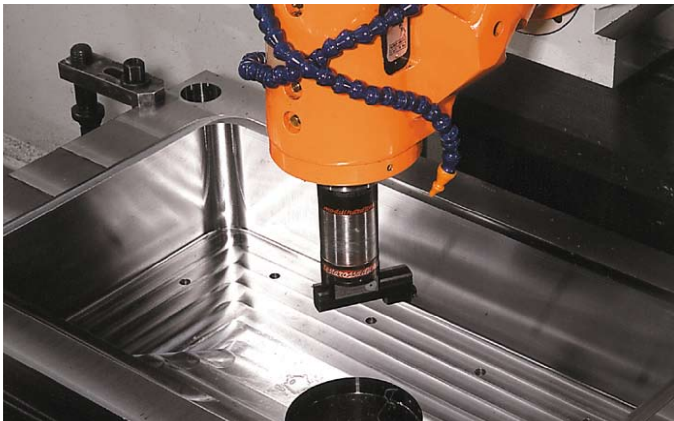
Un momento della lavorazione di fresatura per un portastampo in Sefa Meccanica
