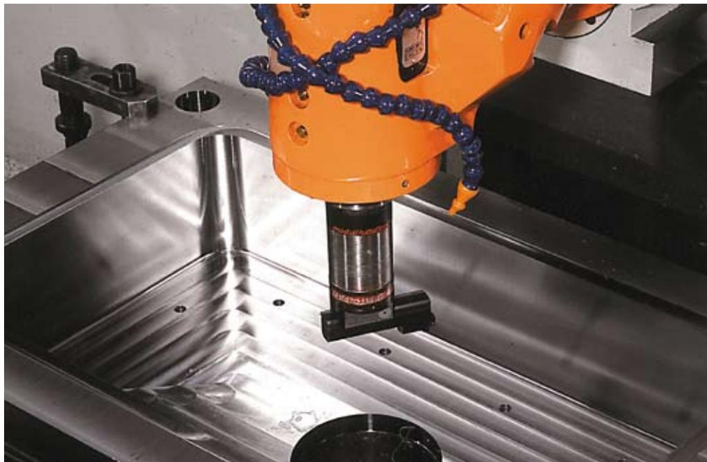
*Un momento della lavorazione di fresatura per un portastampo*
