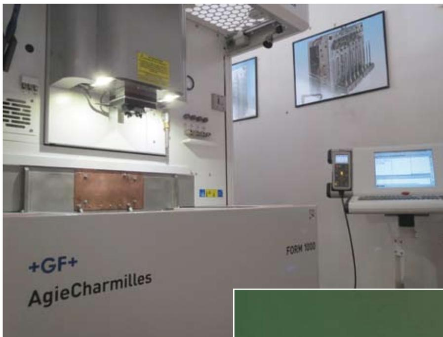
*Sopra, macchina unica in Italia per eseguire impronte di stampi di materiale termoplastico – tramite processo di elettroerosione – dalla superficie frontale di meno di mezzo mm<sup>2</sup>, impiegati nei settori medicale e elettronico.*
