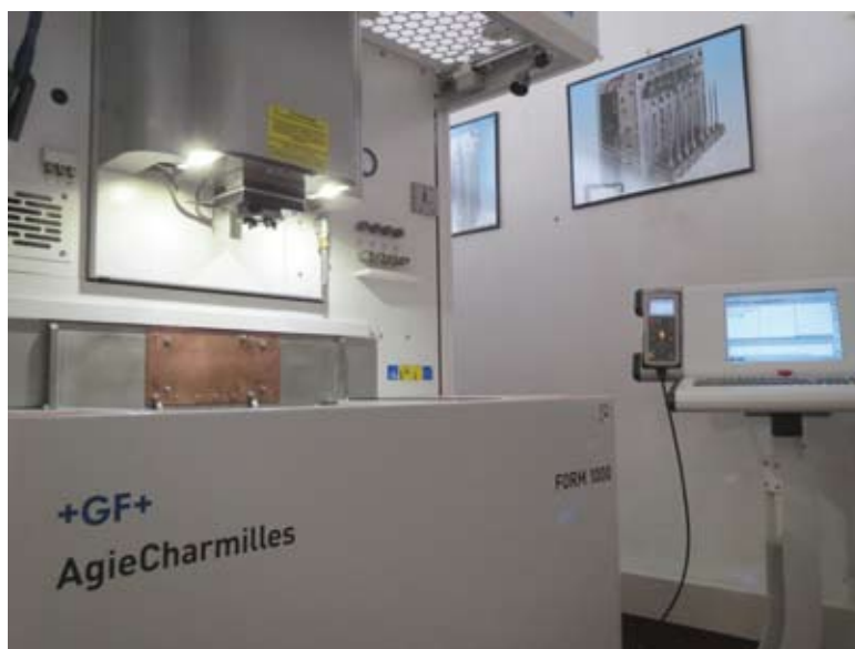
Macchina per eseguire impronte di stampi di materiale termoplastico impiegati nei settori medicale ed elettronico
